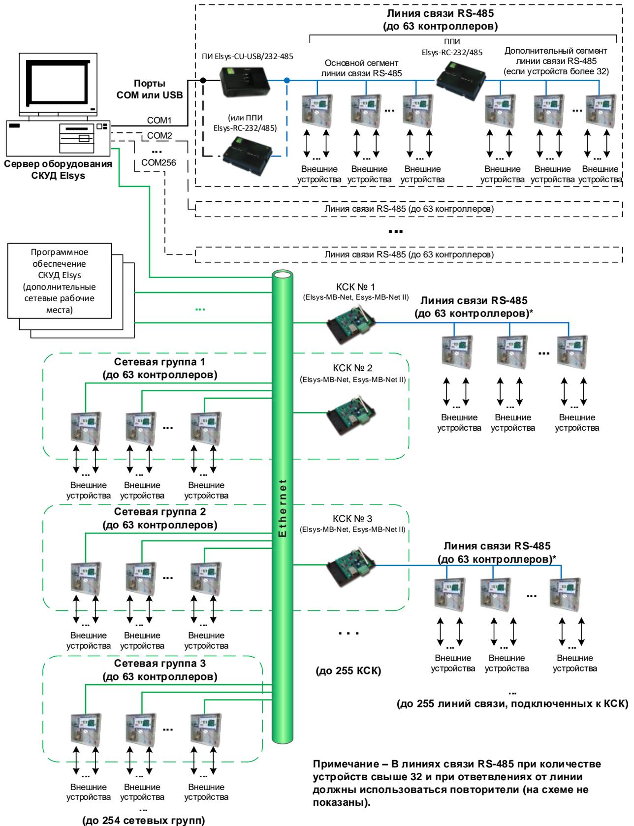
Рисунок 7. Структурная схема СКУД Elsys
