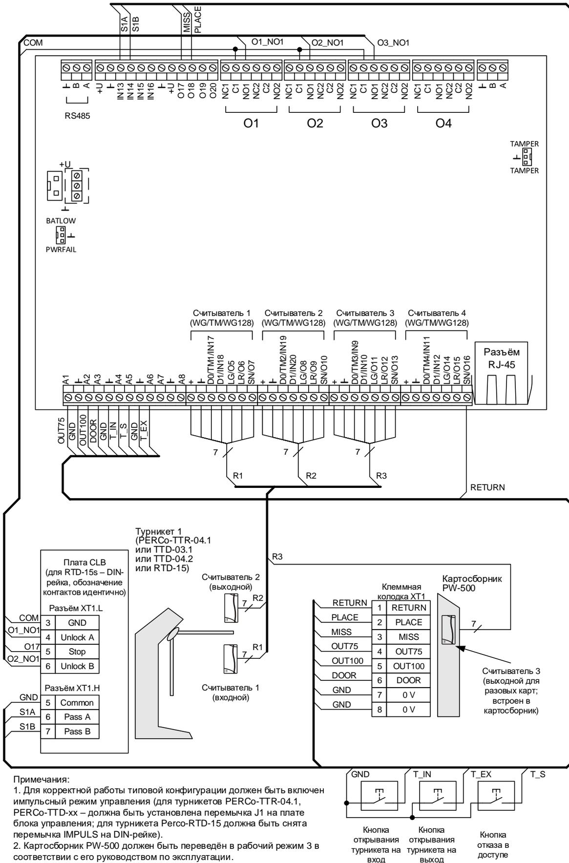
Рисунок 19. Схема подключения турникета PERCo совместно с картосборником PW500
