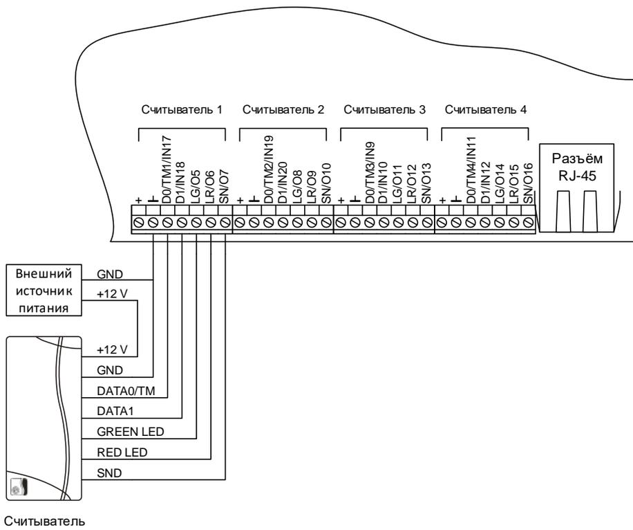
Рисунок 10. Схема подключения считывателя к внешнему источнику питания
